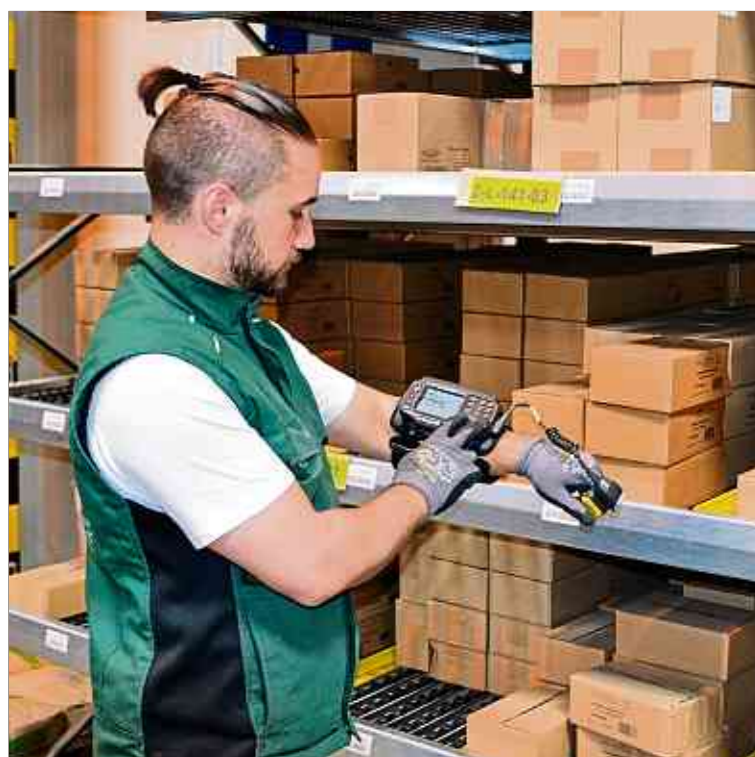
Die Kommissionierung vorbestellter Produkte erfolgt zeitnah über Bestelllisten, die die Lageristen auf Mini-PCs am Handgelenk abrufen.
